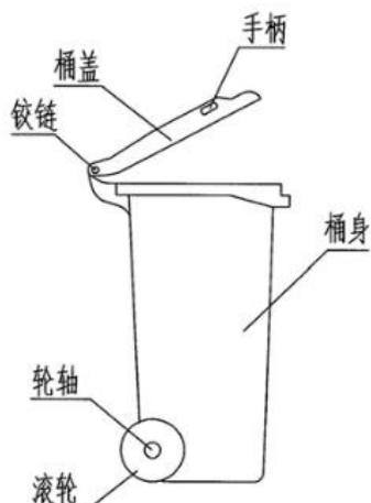
5、技术要求：满足标准 CJ/T280-2008 《塑料垃圾桶通用技术条件》所规定的技术标准要求
